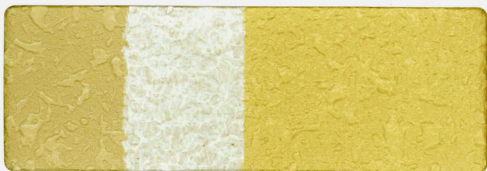
吹付タイル玉吹下地 マスチック微弾性フィラー (ウルローラー) マスチックSU上塗 マスチックSU上塗 103
