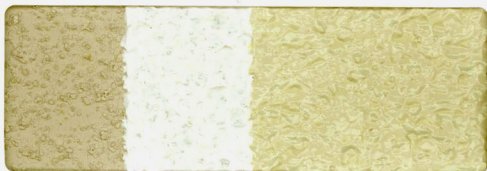
リシン下地 マスチック微弾性フィラー (マスチックローラー) マスチックSi上塗 マスチックSi上塗 102
